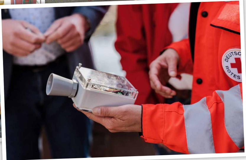
Hilfe zur Selbsthilfe. Der Pegel misst den aktuellen Wasserstand und kann jederzeit abgerufen werden.
